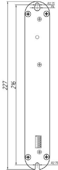
Рис. 7.4. Крепеж модуля Контроллера к стене
